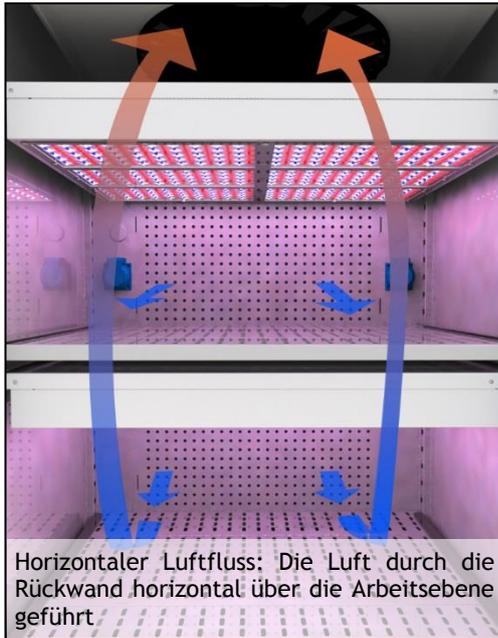
Horizontaler Luftfluss: Die Luft durch die Rückwand horizontal über die Arbeitsebene geführt
